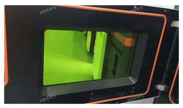
现在市面上的激光防护镜镜片有多种不同材料,比如玻璃镜片,亚克力或者PC镜片,选择不同材料的镜片将取决于所使用的激光的功率和波长。其中玻璃滤光片提供更高的VLT□因此可能不适合某些特定激光器。某些玻璃镜片可以经过专门设计以满足使用者的个人要求,或者可以组合使用玻璃镜片来覆盖所需的波长,比如可以将玻璃镜片制造得更厚,从而增加相同波长的光密度水平。使用玻璃镜片的主要特点: 1. 使用中高功率密度激光器时的比较好解决方案; 2. 增强可见光透射率; 3. 优越的视觉特性; 4. 出色的色彩平衡。相较而言,亚克力或者PC镜片成本更低,镜片还具有抗冲击性,是较重玻璃选件的轻巧替代品。这类镜片可提供宽广的滤光和波长吸收范围。并且近几年这类镜片的加工技术有了巨大的改进,提供了比前几年更高的VLT性能。这类镜片的优点在于: 1. 许多产品都具有抗冲击性,并完全符合EN207标准和CE认证; 2. 通常可用于较普遍的框架和样式; 3. 更实惠。
